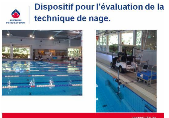
Figure 8 - Type de chariot motorisé permettant l'analyse de la nage sous-marine.
